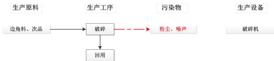
图 2-4 本项目破碎工艺流程及产污环节图
