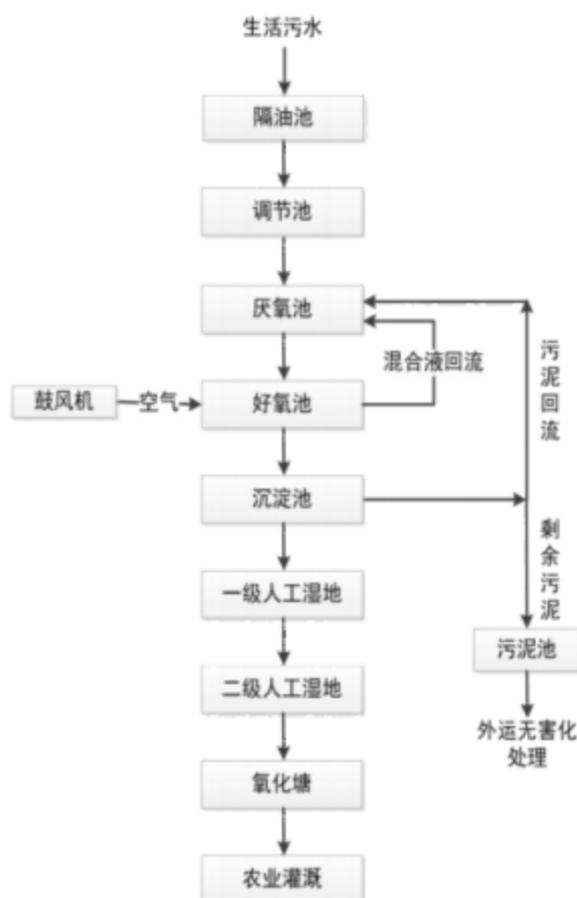
图4.2 花都区炭步镇环山村工业园污水处理站工艺流程
