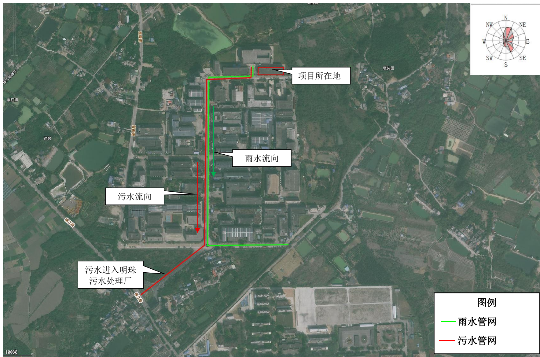
附图 18 区域雨污水管网走向图
