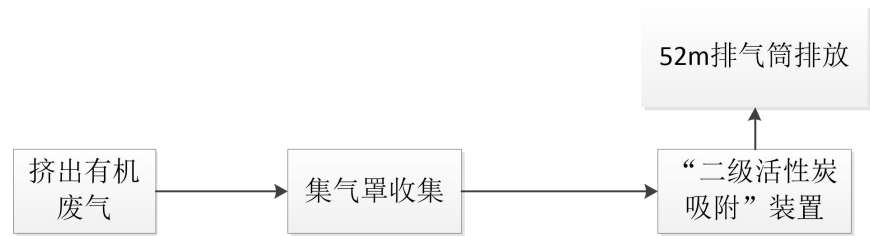
图 4-1 项目废气处理工艺流程图
