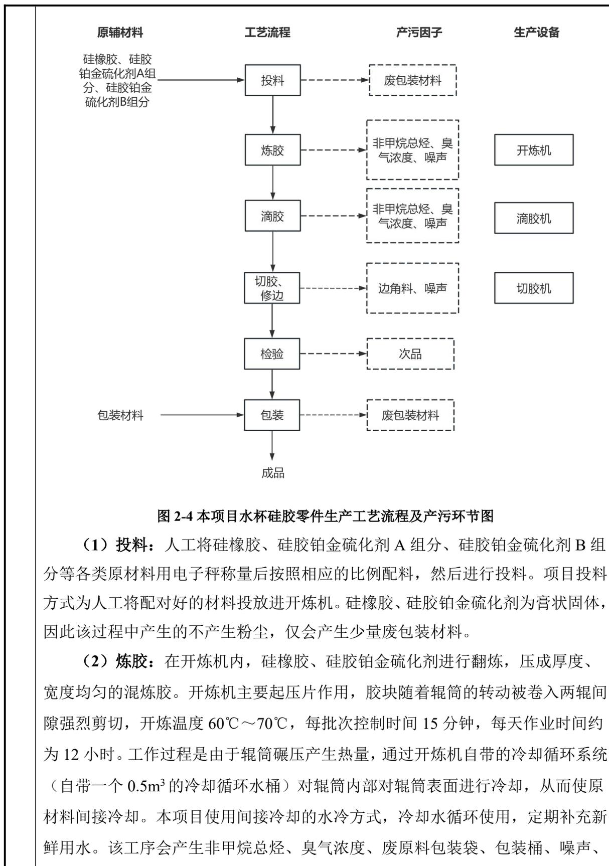
图 2-4 本项目水杯硅胶零件生产工艺流程及产污环节图
