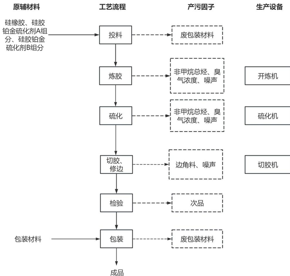
图 2-3 本项目餐具硅胶零件生产工艺流程及产污环节图
