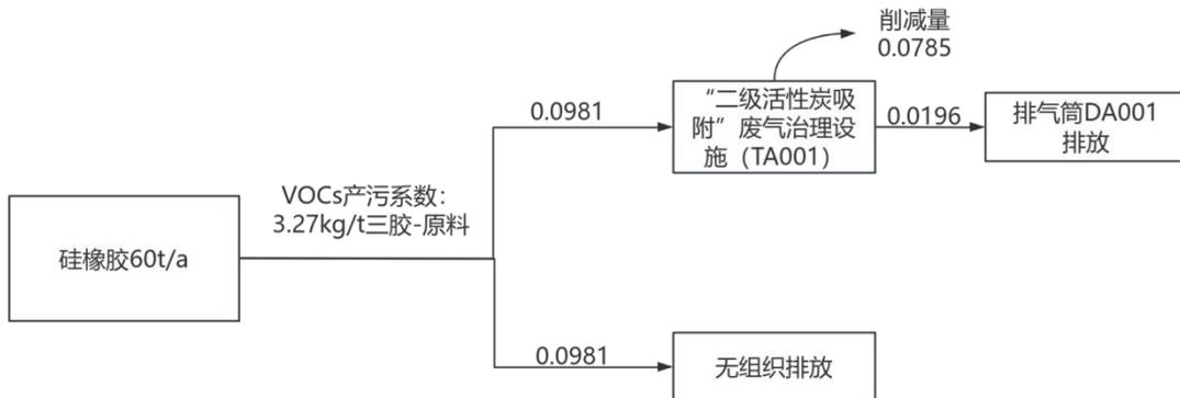
图 2-2 本项目有机废气平衡图 (单位  $\text{t}/\text{a}$ )
