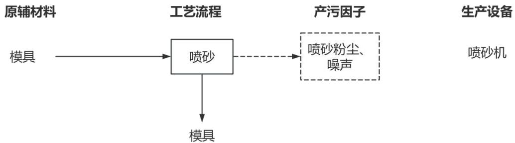
图 2-5 本项目模具喷砂工艺流程及产污环节图
