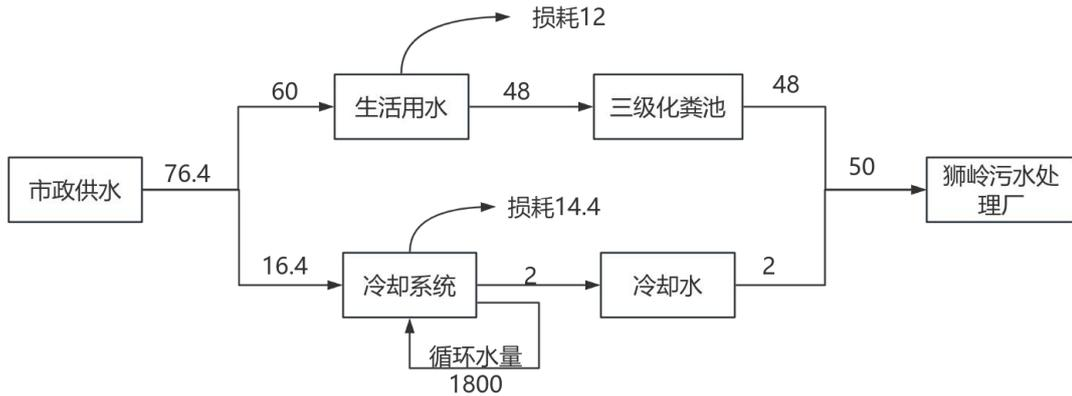
图 2-1 本项目水平衡图 (单位  $\text{m}^3/\text{a}$ )
