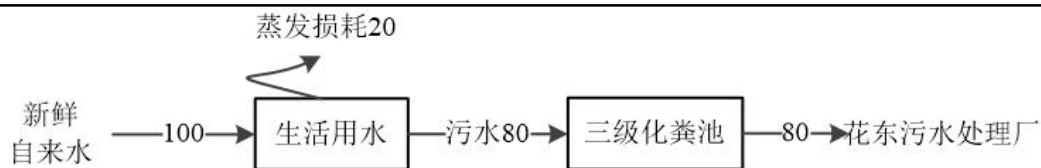
图 2-1 本项目水平衡图 (单位 \text{m}^3/\text{a} )
