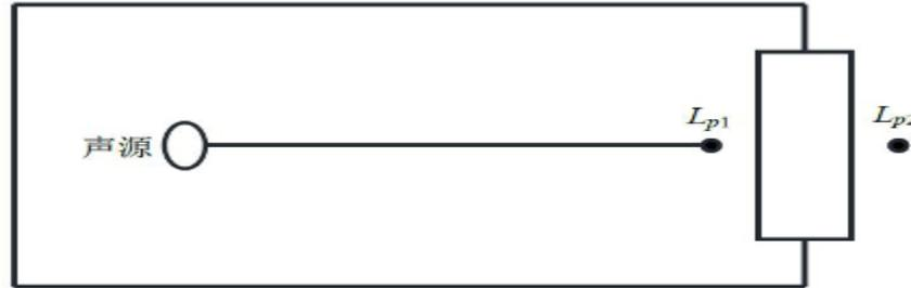
图 4-2 室内声源等效为室外声源图例
