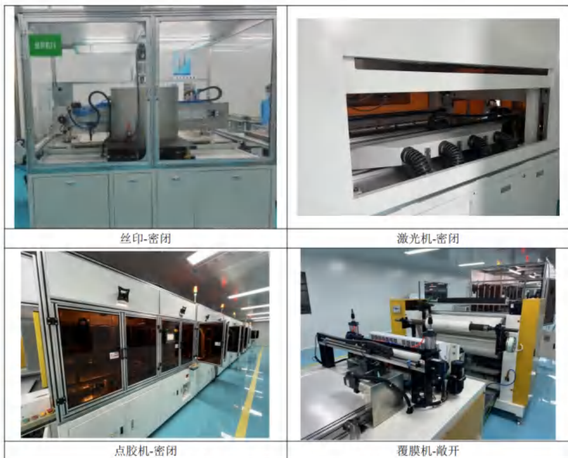
图 4-1 同类企业杭州高烯相关设备密闭情况照片
