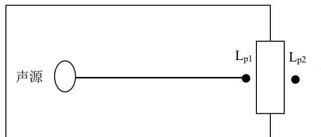
图 4-1 室内声源等效为室外声源图例
