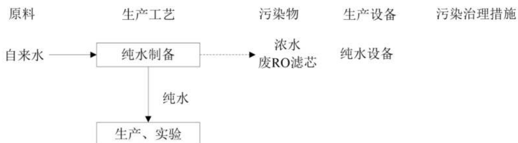
图 2-5 项目纯水制备流程图
