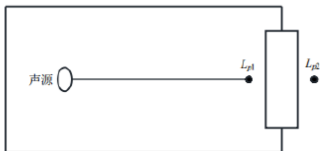
图 4-1 室内声源等效为室外声源图例
