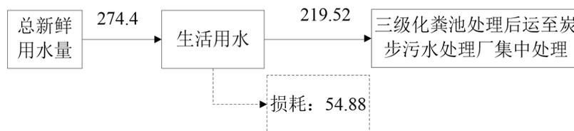
图 2-2 项目近期水平衡图 (t/a)
