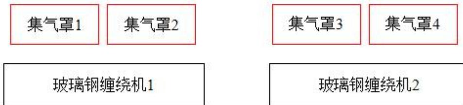
玻璃钢缠绕机顶部集气罩设置平面图
