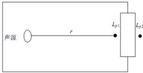
图 4-2 室内声源等效为室外声源图例
