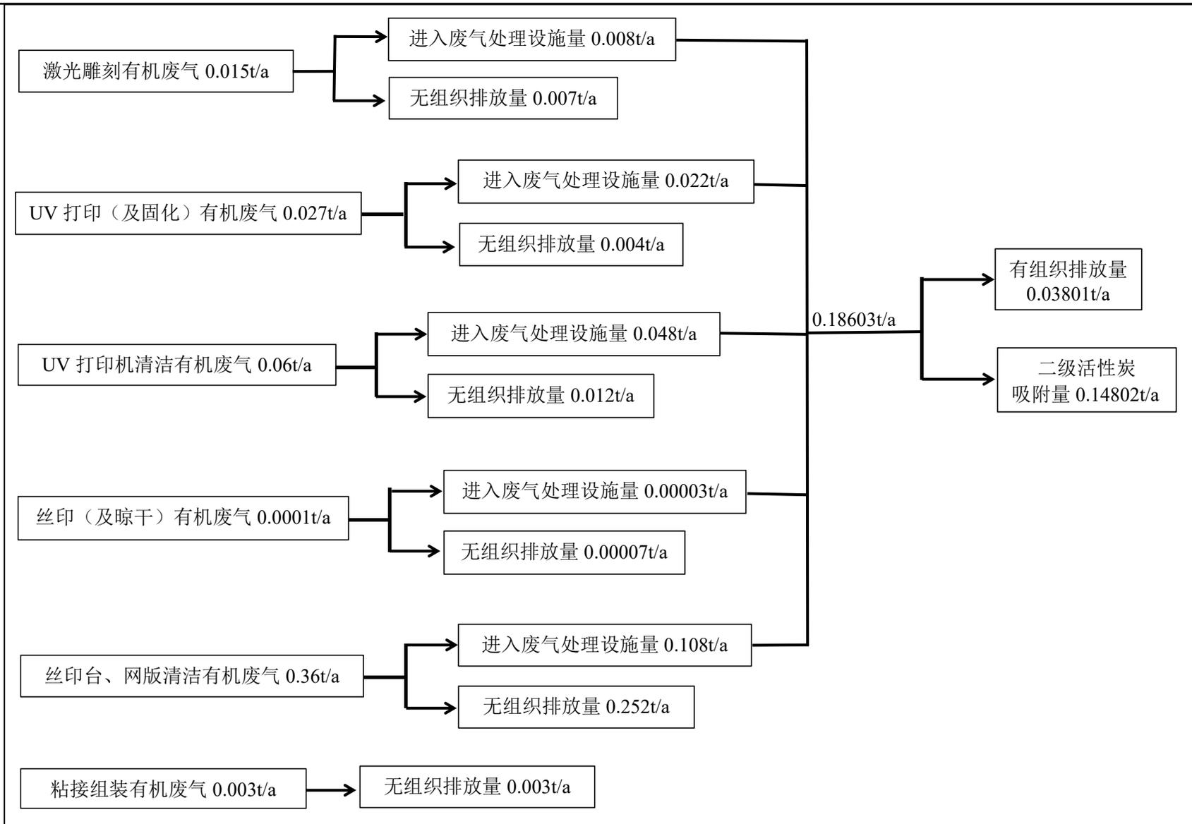
图 4-1 项目有机废气平衡图（单位：t/a）
