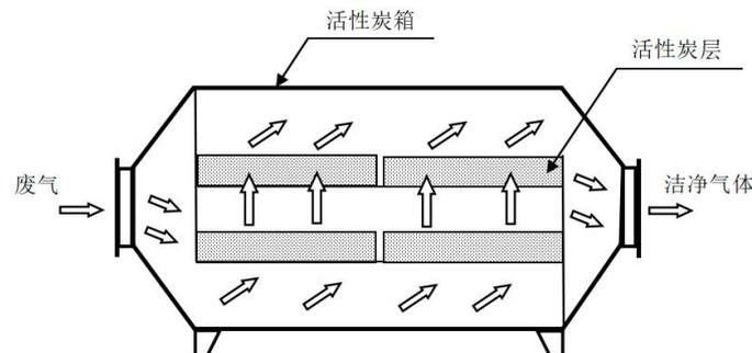
本项目有机废气处理系统中活性炭吸附箱过滤风速为 0.8m/s，符合《吸
