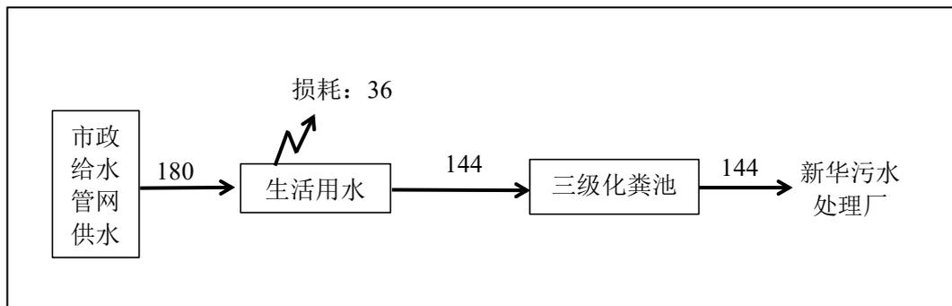
图 2-1 项目水平衡图 (单位: m<sup>3</sup>/a)
