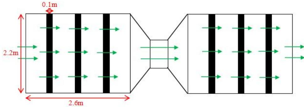
图 4-1 废气处理设施气流走向图（正面图）
