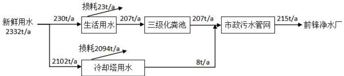
图 2-2 改扩建后项目水平衡图
