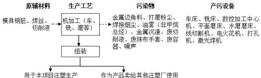
图 2-4 本项目注塑模具生产工艺流程及产污环节图
