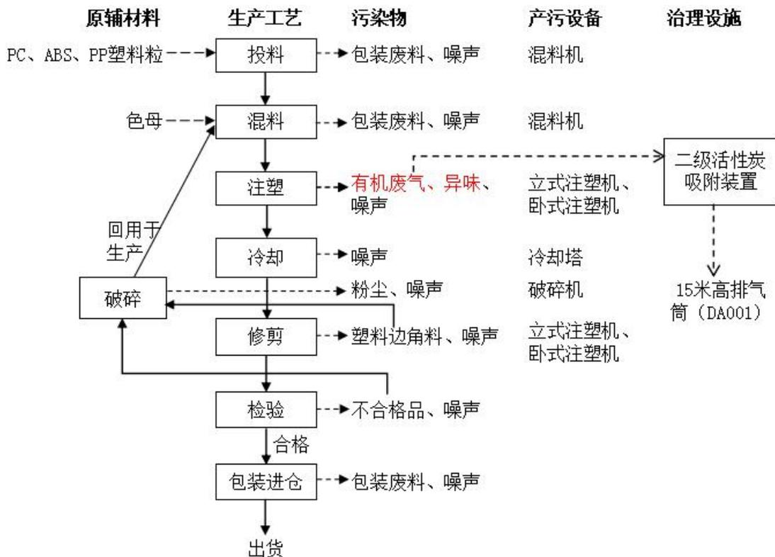
图2-5 原项目塑料制品生产工艺流程及产污环节图
