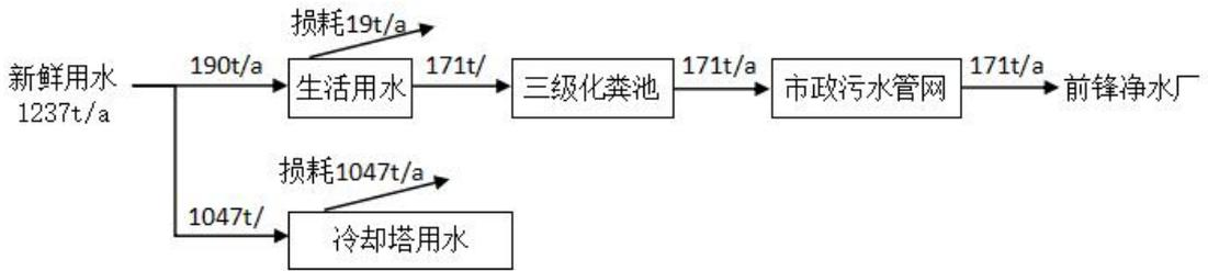
图 2-1 原项目水平衡图
