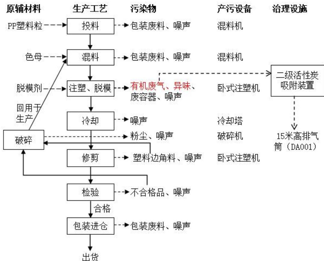
图 2-3 本项目塑料制品生产工艺流程及产污环节图
