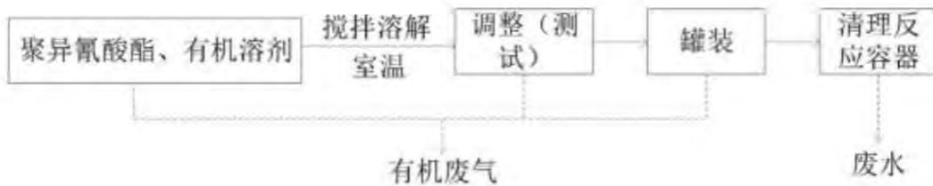
图 2-8 硬化剂研发工艺流程及产污节点图
