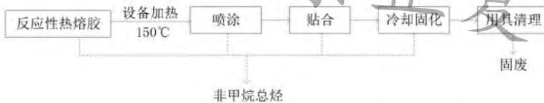
图 2-10 反应性热熔胶产品应用测试流程及产污节点图
