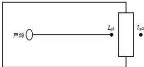
图 4-1 室内声源等效为室外声源图例
