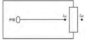
图 4-2 室内声源等效为室外声源图例
