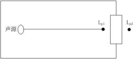
图 4-4 室内声源等效为室外声源图例
