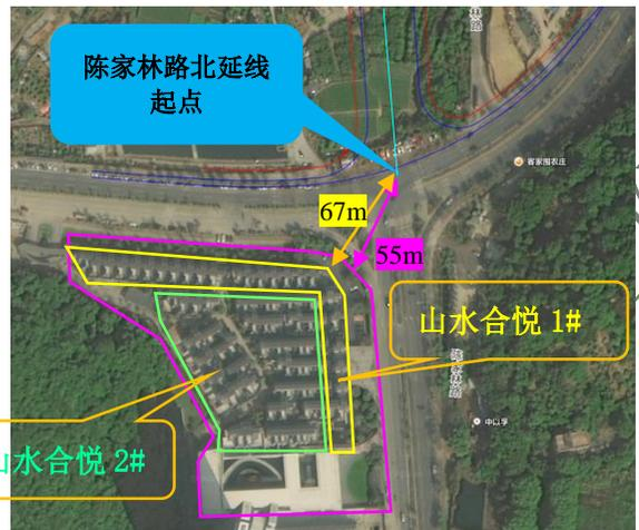
山水合悦位于陈家林路北延线起点西南侧, 敏感建筑距道路起点中心线最近距离为 67m, 未受到陈家林路北延线水平方向交通噪声影响, 故无与陈家林路北延线水平方向的剖面关系图
