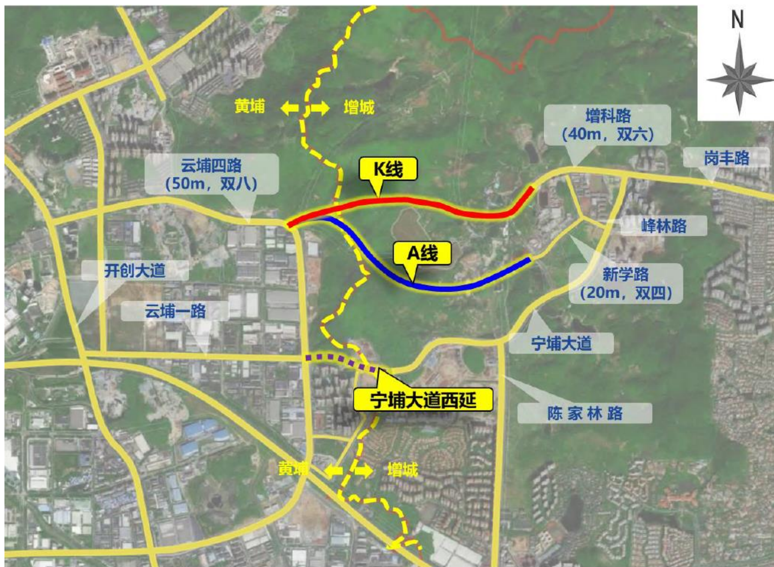
图 3.1-12 项目路线比选方案示意图
