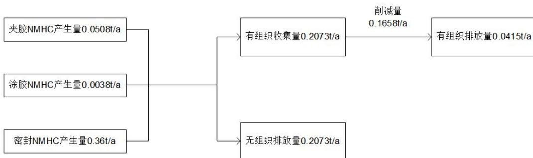
图 4-2 项目有机废气平衡图
