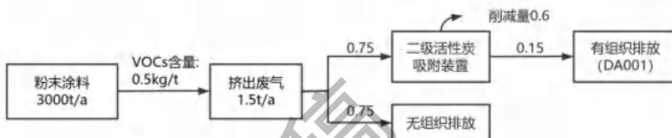
图 2-2 本项目 VOCs 平衡图
