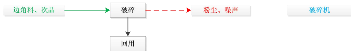
图 2-4 本项目破碎工艺流程及产污环节图
