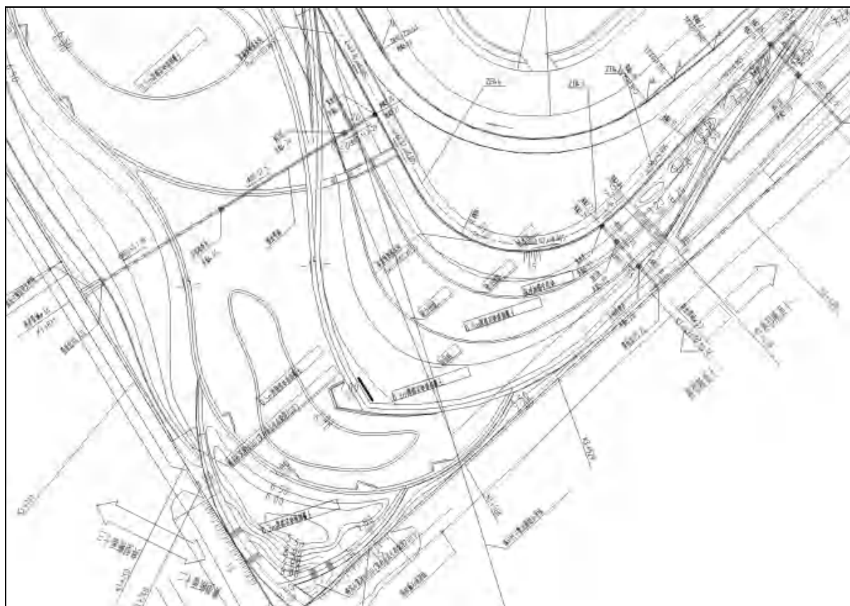
图 3.1.4-22f 本项目部分排水管涵布置图
