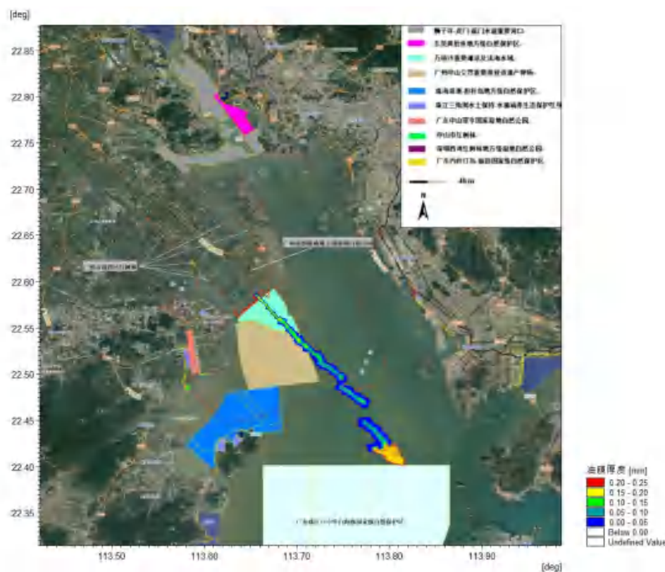
图 6.3.4-11 溢油 O2 点油膜运动轨迹图（工况 5） （大潮涨潮期，最不利风向 NW，极端风速 13.8m/s，绘制时间间隔 10min）
