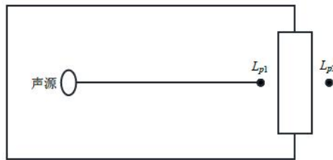
图 4-1 室内声源等效为室外声源图例
