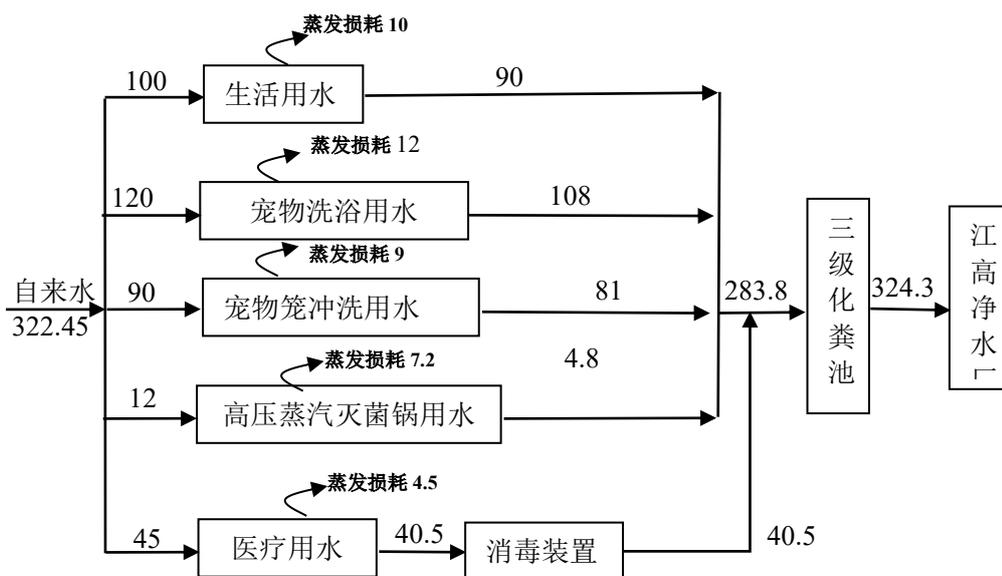
图 2-1 本项目水平衡图 (单位:  $\text{m}^3/\text{a}$ )
