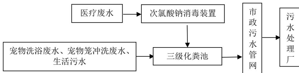
图 4-2 废水处理工艺流程图
