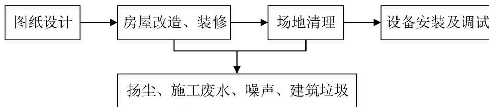
图 2-2 施工期工艺流程及产污流程图
