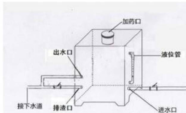
图4-3 项目废水消毒设备示意图
