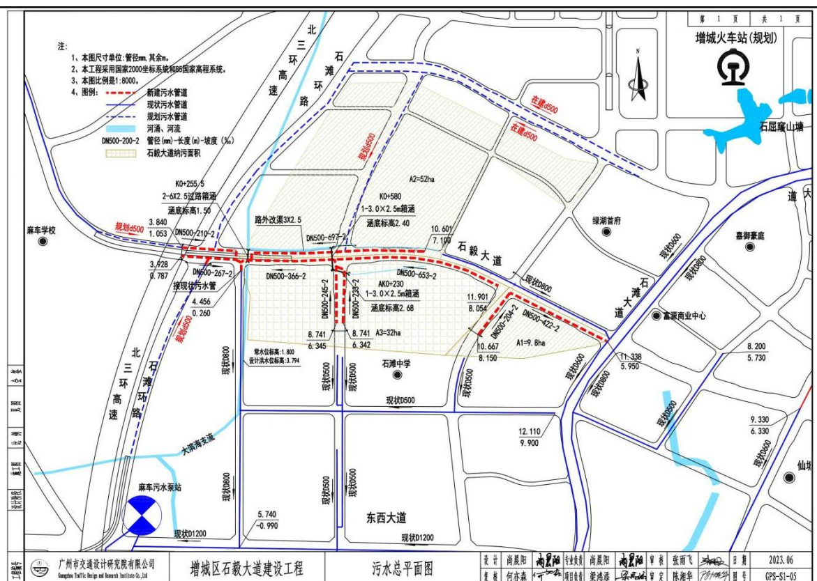
图 2-7 项目污水管网平面图
