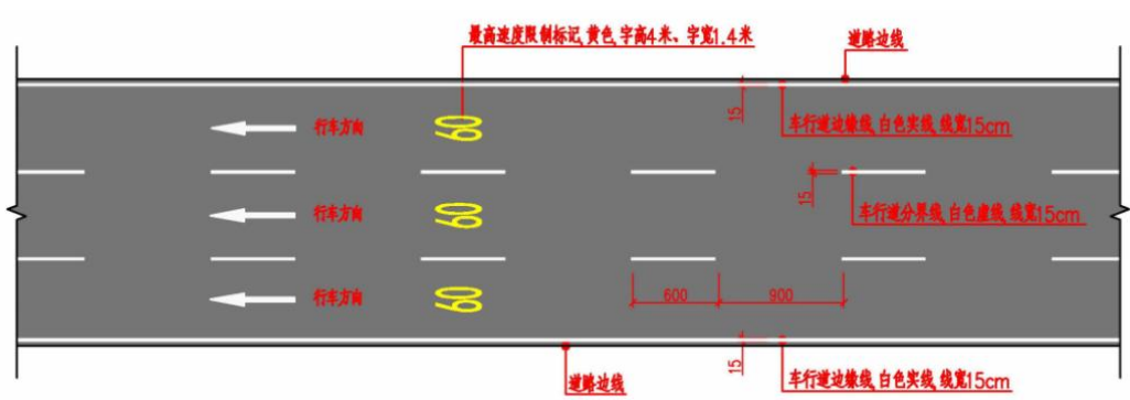
图 2-10 交通标线设计大样图
