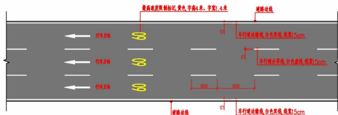
图 2.2-10 交通标线设计大样图
