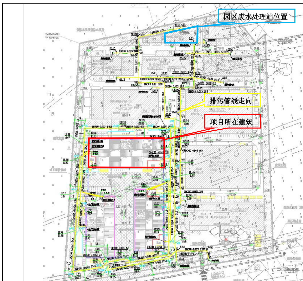
图 4-4 项目所在园区废水管网走向图
