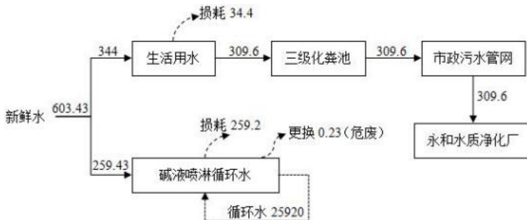
图 2-3 改建完成后全厂水平衡图 (m³/a)
