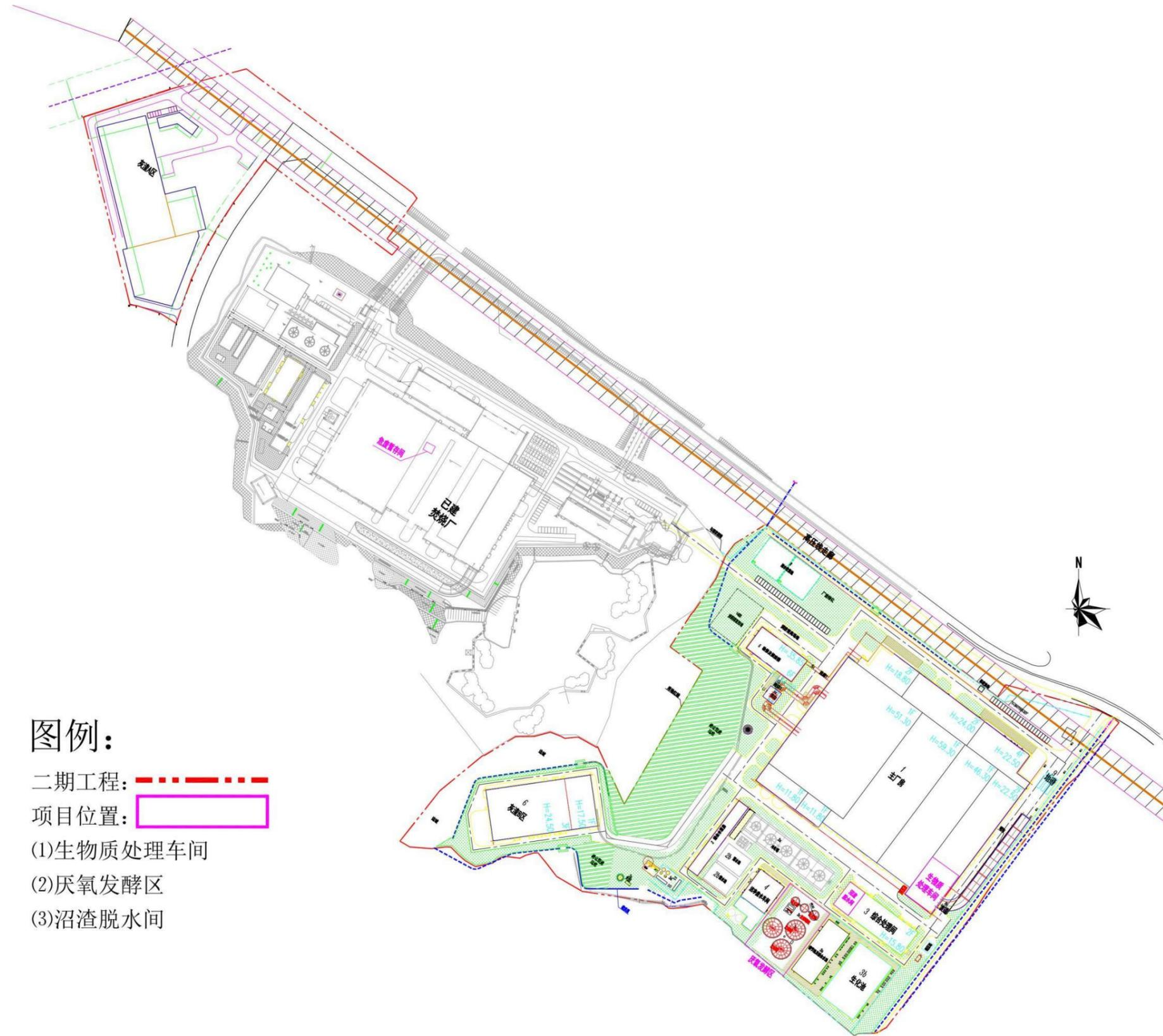
图 4.2-1 项目总平面布置图
