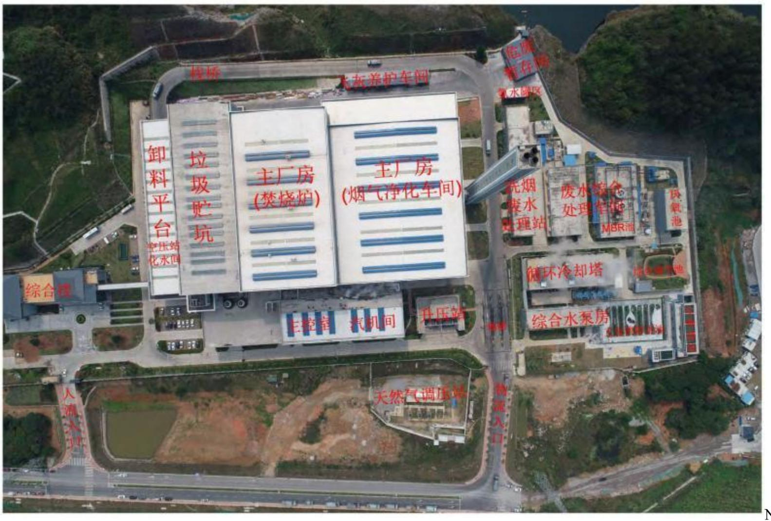
图 3.2-1 第六资源热力电厂一期工程平面布置图
