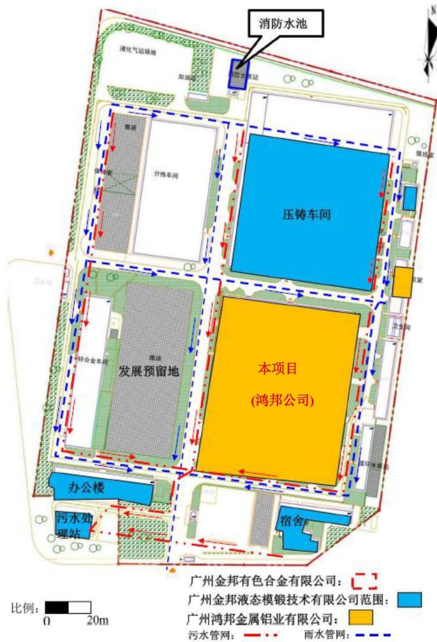
附图 13 项目雨污管网图
