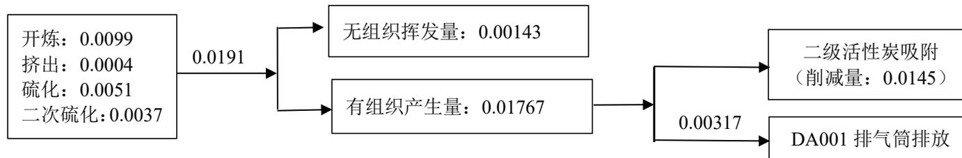
图 4.2 项目全厂有机废气平衡图 (t/a)
