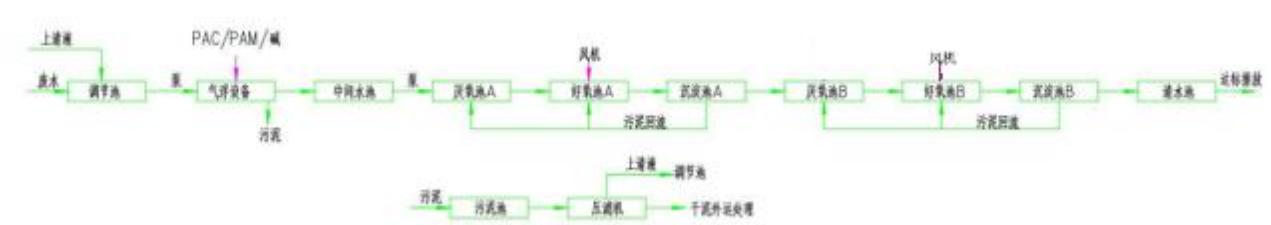
图4-1 自建废水处理站生产废水处理工艺流程图
