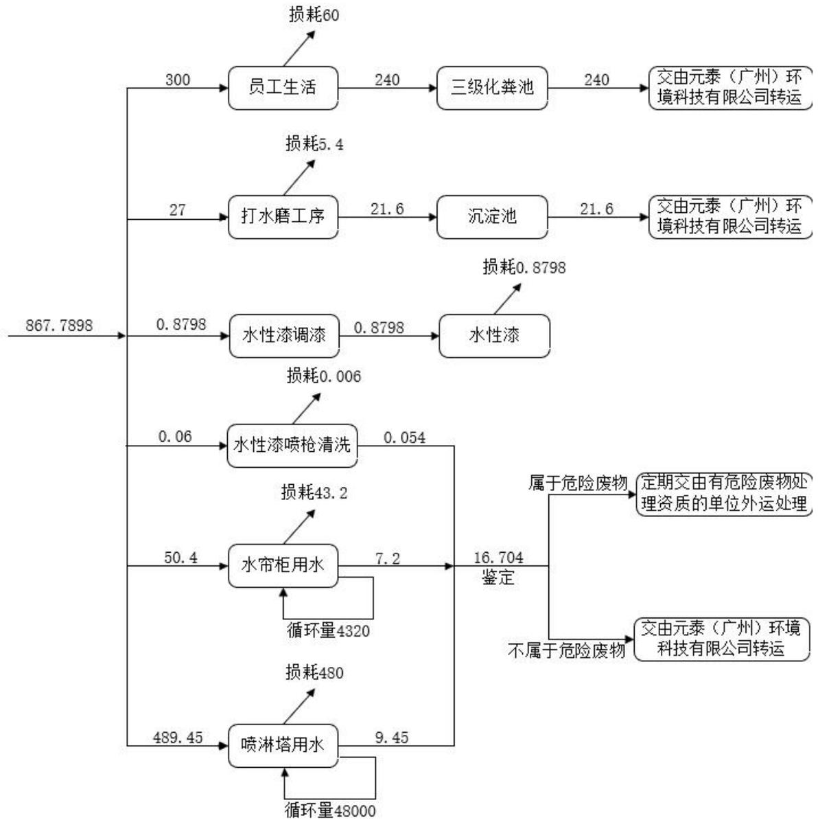
图 2-1 项目近期水平衡图 单位：t/a
