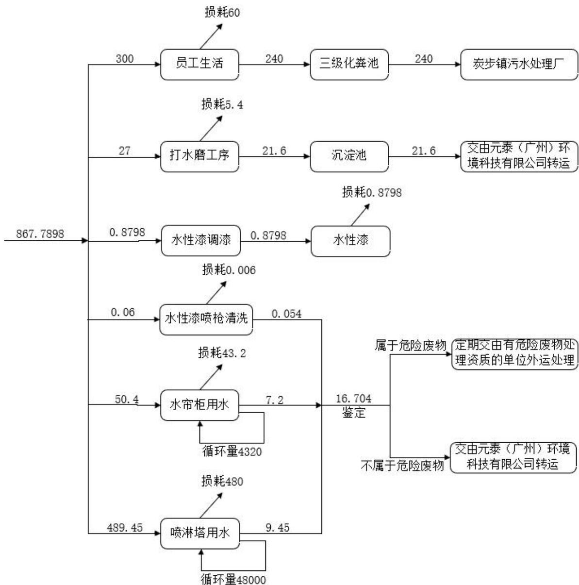
图 2-2 项目远期水平衡图 单位: t/a
