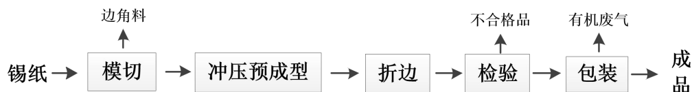
图 2-11 锡纸盒生产工艺流程图
