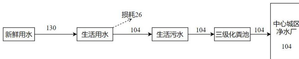
图 2-1 本项目水平衡图 (m<sup>3</sup>/a)
