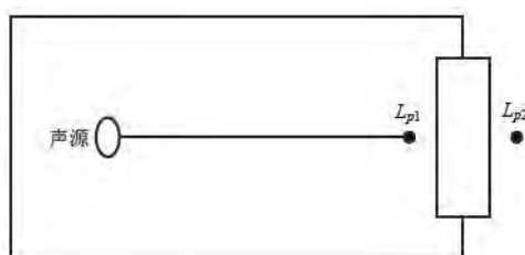
图 4-1 室内声源等效为室外声源图例
