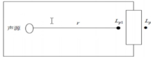
图 4-2 室内声源等效为室外声源图例
