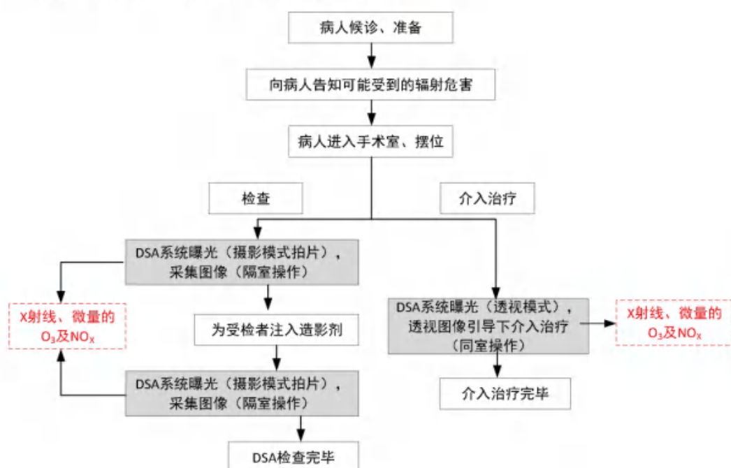
图 9-3 DSA 操作流程及产污环节示意图
