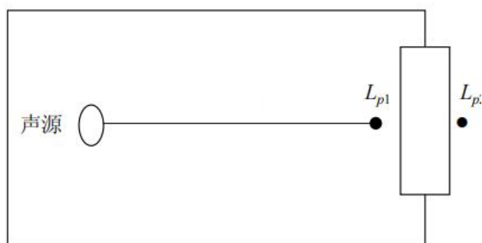
图 4-1 室内声源等效为室外声源图例
