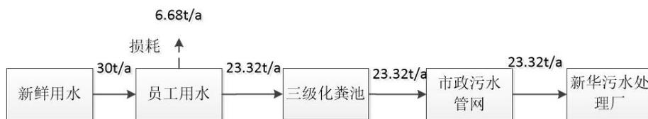
图 2-1 本项目水平衡图 (t/a)
