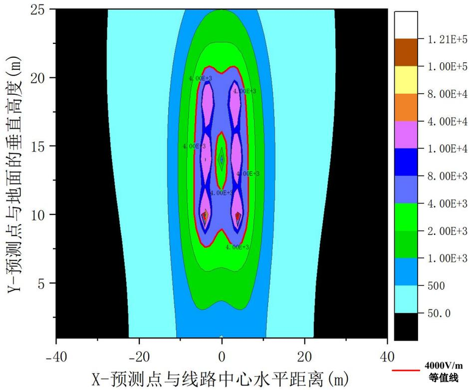
专题图 I-4 本项目工频电场预测达标等值线图 (单位: kV/m)
