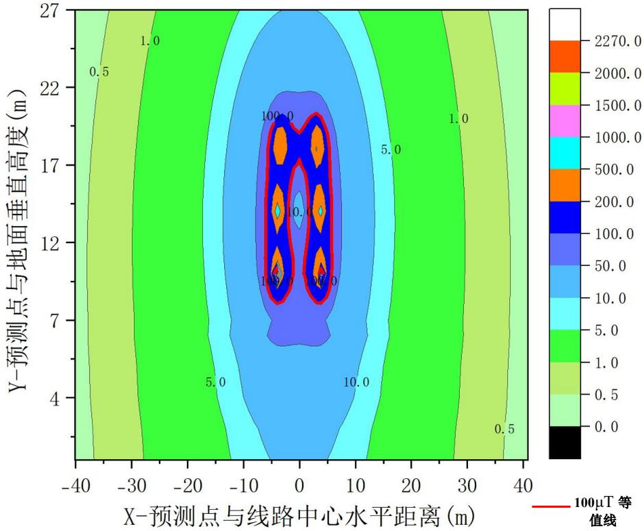
专题图 I-5 本项目工频磁感应强度预测达标等值线图 (单位:  $\mu\text{T}$ )
