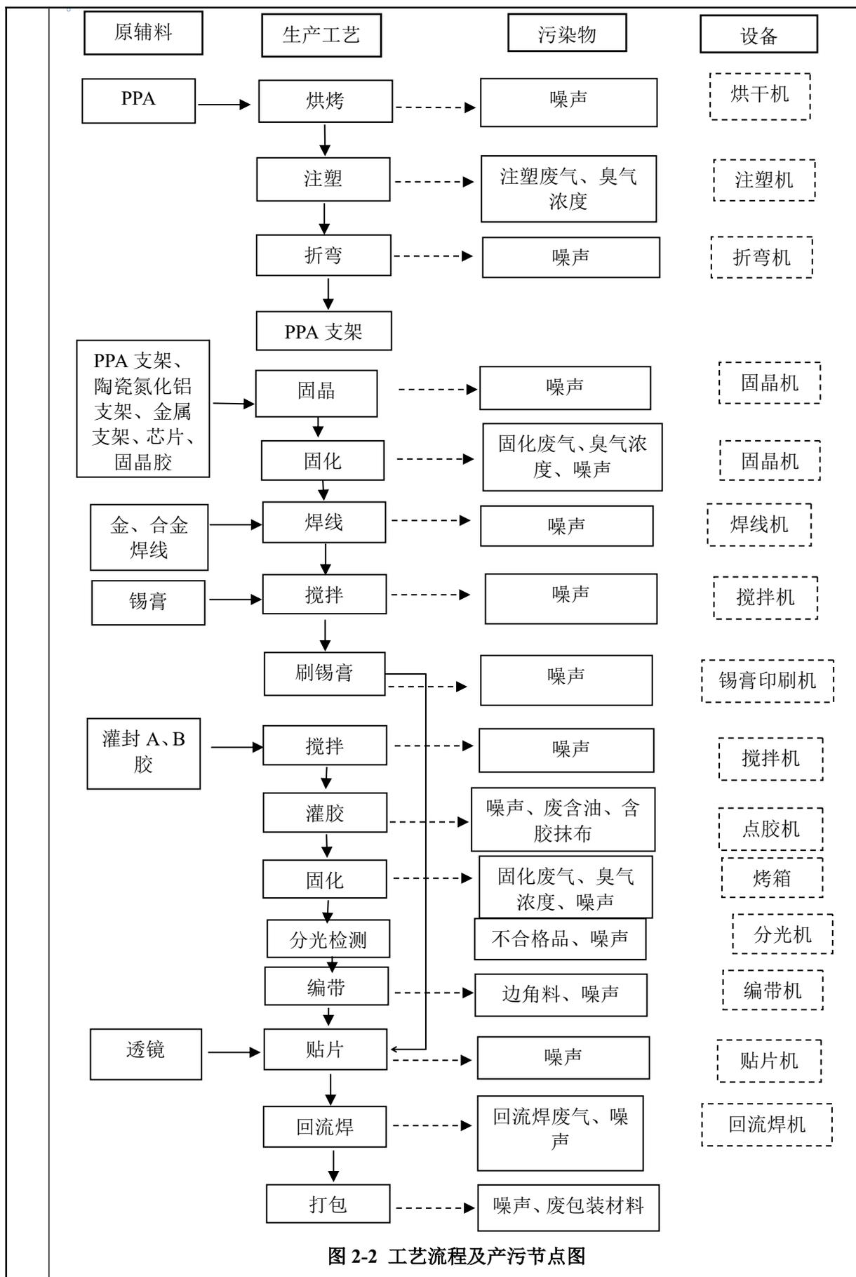
图 2-2 工艺流程及产污节点图
