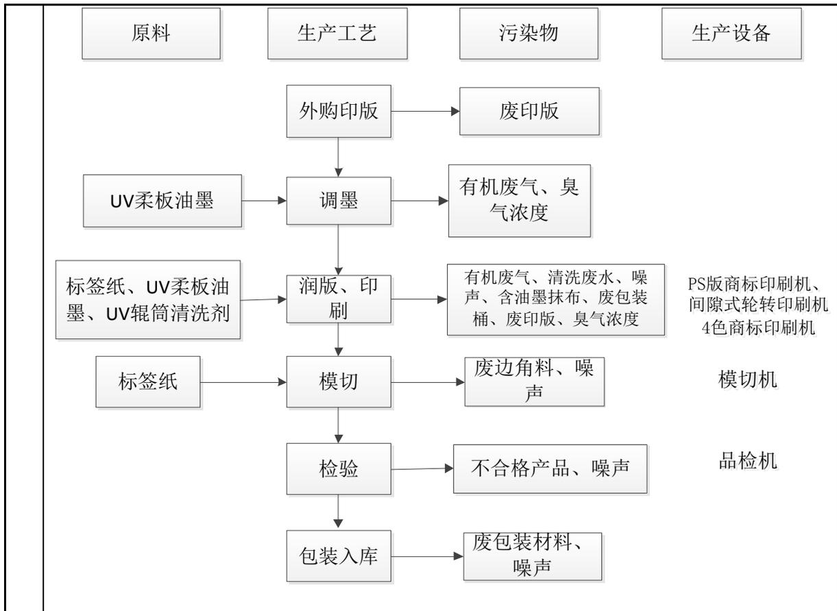
图 2-3 原项目标签纸印刷生产工艺流程图
