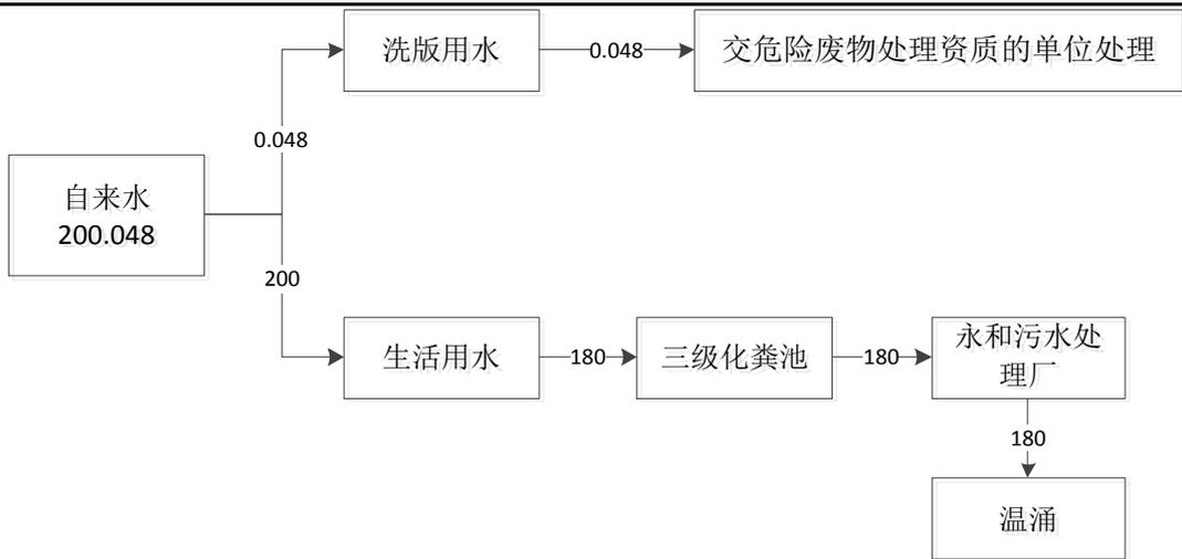
图 2-1 项目水平衡图（单位：m<sup>3</sup>/a）
