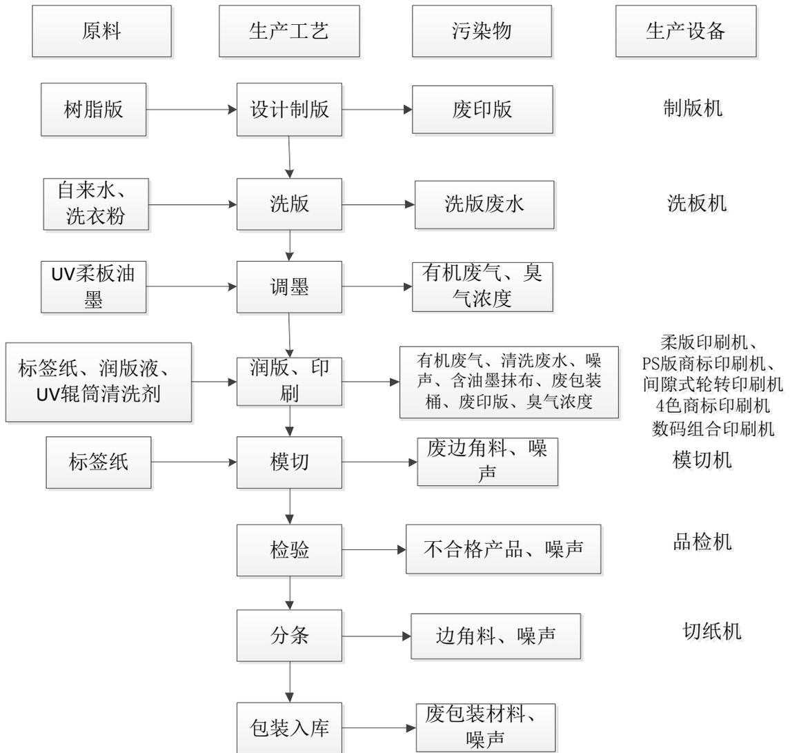
图 2-2 生产工艺流程图
