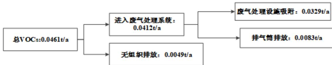
图 4.1 项目全厂有机废气平衡图
