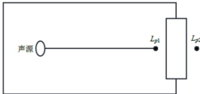
图 4.6 室内声源等效为室外声源图例
