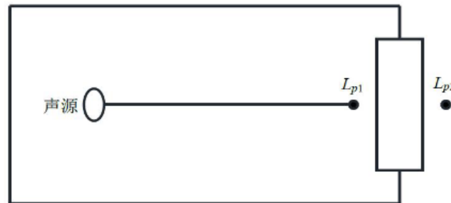
图 4-2 室内声源等效为室外声源图例
