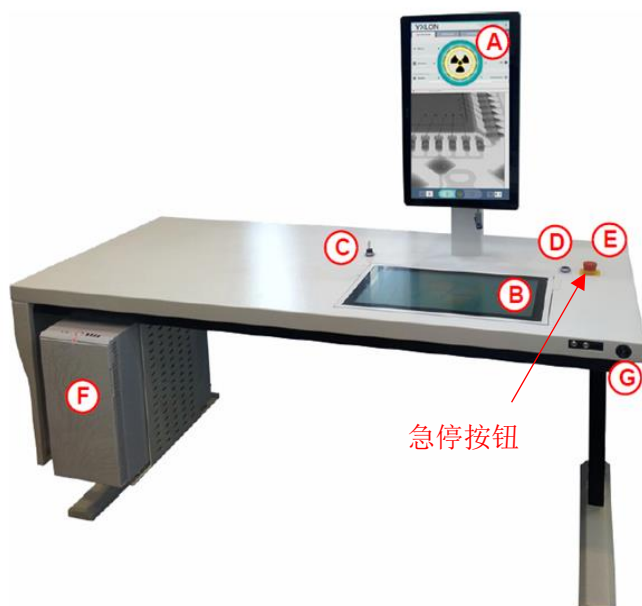
图 10-8 操作台设置的急停按钮
