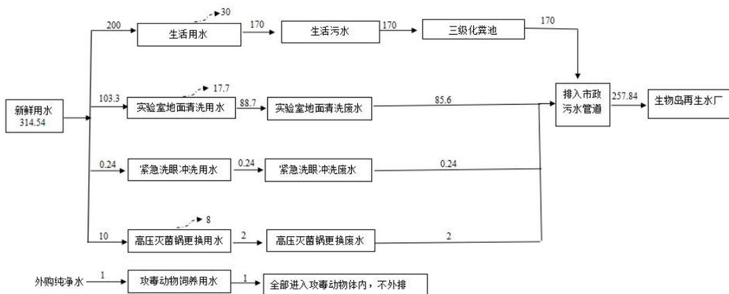
图2-3 扩建后项目用水平衡示意图 (单位:  $m^3/a$ )
