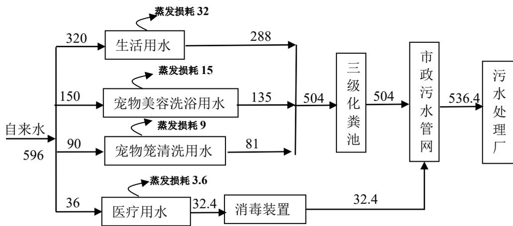
图 2-1 项目水平衡图 (m<sup>3</sup>/a)
