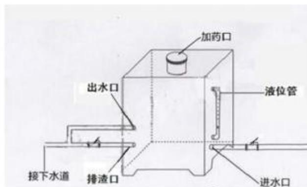
图4-2 项目废水消毒设备示意图
