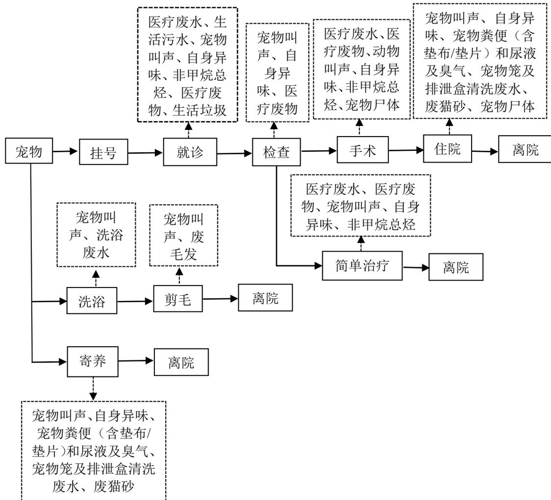
图 2-3 营运期工作流程及产污流程图
