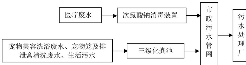
图 4-1 废水处理工艺流程图
