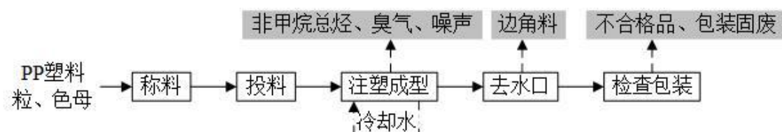
图 2-3 本项目生产工艺流程及产污图
